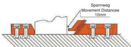
Die Winkelauffläche ist für dünne Werkstücke und die gerade Fläche für dicke Werkstücke.
