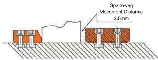
Die Winkelauflegefläche ist für dünne Werkstücke und die gerade Fläche für dicke Werkstücke.
