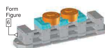
Spannen mit Weichbacken Figure clamping with soft legs
