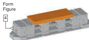
Spannen empfindlicher Teile auf Parallelen Figure clamping thin workpiece on motion parallels
